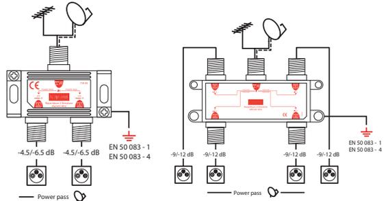
Raccorder les répartiteurs télévision 2 ou 4 sorties au bornier de terre du coffret
