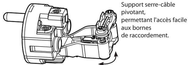
Support serre-câble pivotant, permettant l'accès facile aux bornes de raccordement.
