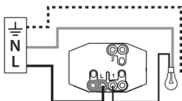
En va-et-vient, commande de 2 endroits différents
